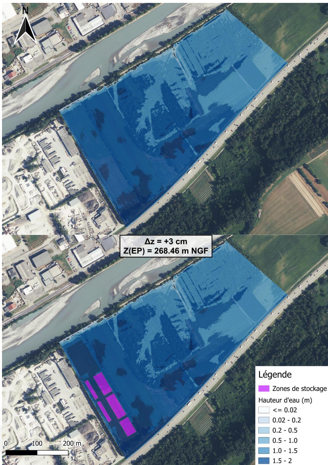
Figure 3-1 : Hauteurs d'eau à l'état initial (haut) et à l'état projet (bas) dans le casier de référence – Q100
